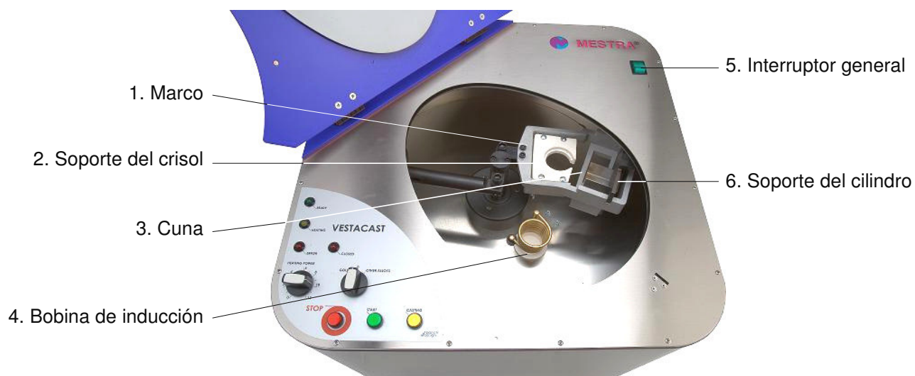
Fig. 2: Cámara de colado con el brazo
