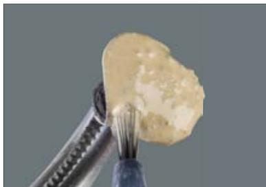
Antes de aplicar el opáquer se recomienda humedecer primero el pincel con OPAQUE LIQUID. Para que la polimerización sea completa, el opáquer se aplica en capas delgadas sobre la estructura y se polimeriza capa por capa. Se aplican tantas capas delgadas de opáquer como sea necesario (dos como mínimo) para que el metal quede completamente cubierto. El opáquer ya mezclado debe cubrirse con una tapa oscura entre paso y paso de polimerización.
