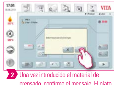
2 Confirme el mensaje. Al hacerlo, el elevador desciende a la posición inferior.
