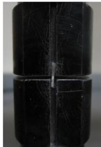
Fig 2. Aparato para medir la fuerza de microtracción usada en este estudio
