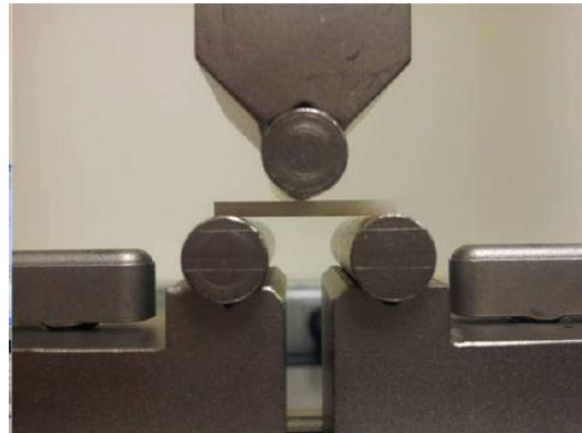
Figura 2. Máquina de ensayos universales con dispositivos para estudio de Flexión.
