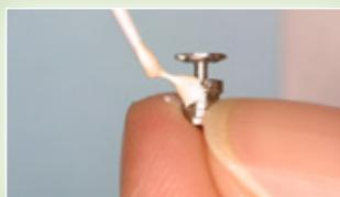
Aplicación del material compuesto autocurable para parar la llave de bloque e insertar el perno deslizante en el mismo agujero.
