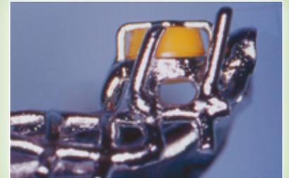
Contenedor y pernos de retención fundidos y terminados con cofia de retención insertada.
