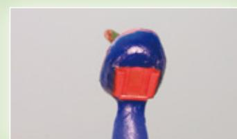
Domo con base guía calcinable y cuele de fundición listo para ser revestido.
