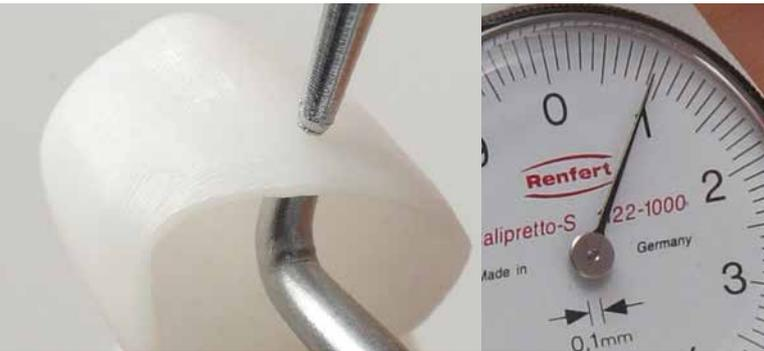
Sistema de medición de precisión del espesor de pared de objetos de prótesis dental.
