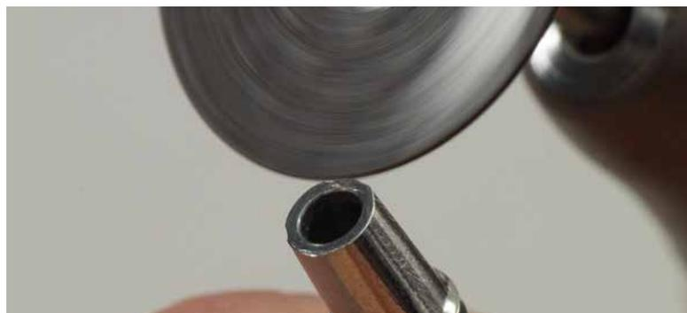
Discos separadores y de corte flexibles y estables, reforzados en fibra de vidrio, especiales para cortar y pulir supraestructuras de implantes como pilares y puentes de titanio o aleaciones de titanio.
