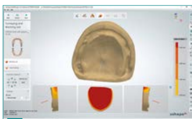
5 Definir la dirección de inserción. Deben tenerse en cuenta las socavaduras.
