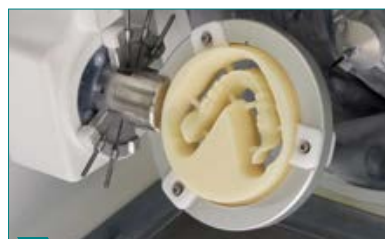
3 Fresar el disco de cera para el encerado para prueba en boca de tamaño completo (maxilar inferior).
