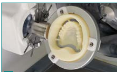
2 Fresar el disco de cera para el encerado para prueba en boca de tamaño completo (maxilar superior).
