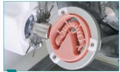
3 3 Fresar la base de prótesis inferior definitiva.
