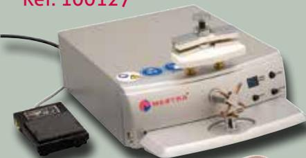
La máquina está controlada electrónicamente, lo que prácticamente elimina las chispas que normalmente se producen entre electrodos en las máquinas sin regulación. La potencia puede seleccionarse entre 30 niveles diferentes para adecuarse a los requerimientos de espesor del material que se desea soldar.
