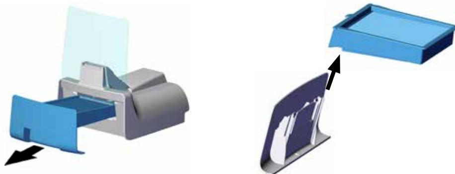
⇒ Staubschubladenblende inkl. Filterelement entnehmen.
